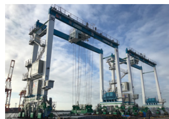
神戸国際コンテナターミナル、横浜港の南本牧ふ頭コンテナターミナルに導入済のニアゼロエミッション型トランスターナ®(写真：横浜港の南本牧ふ頭)
